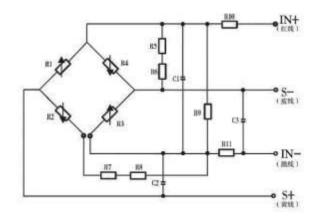
IN+(红线)-供电正 IN-(黑线)-供电负 S+(黄线)-输出正 S-(蓝线)-输出负
